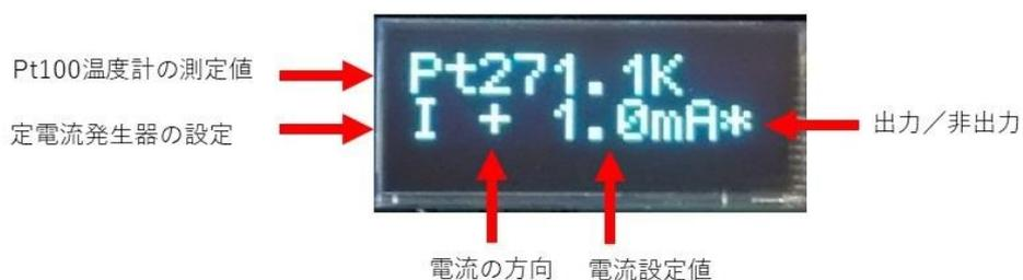
Pt100 温度計は端子が接続されていない場合や断線した場合には温度表示のみ「---.-K」となる。定電流発生器は出力設定時において端子が接続されていない場合や断線した場合には電流値表示が「---.-mA」となる。この場合で変更可能な設定値は「出力／非出力」のみとなる。
