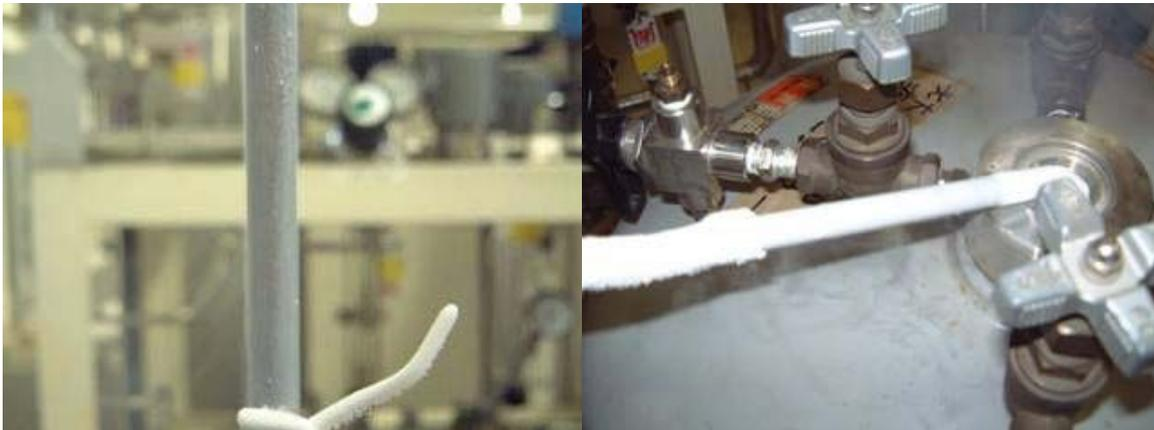
(3) ゴム管の方だけ温め、LN<sub>2</sub>容器からポールを抜き、もう一度N<sub>2</sub>ガスを送り、LN<sub>2</sub>が出ないか確かめる。
