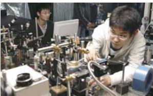
ミリケルビン温度域でのフォノンダイナミクスの測定を可能とする極低温レーザー分光システム
