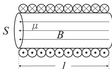
2-1. アンペールの法則を使って、内部の磁束密度の大きさ  $B$  を、 $I$  を用いて表しなさい。
