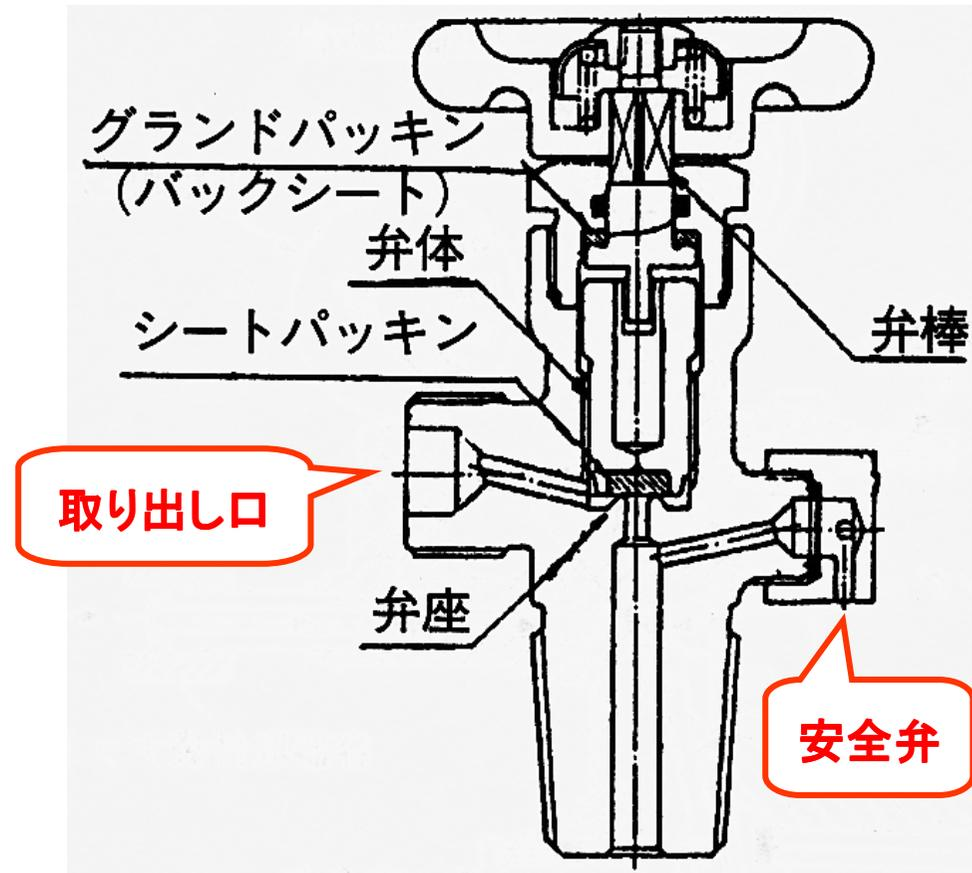
バックシート式バルブの断面図
