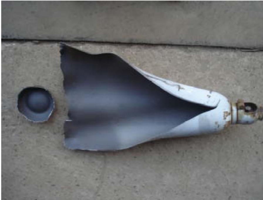
＜保管中のガスボンベが破裂！！＞
