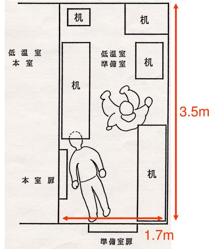
17m<sup>3</sup>の実験室内に80Lの液体窒素を投入したために
