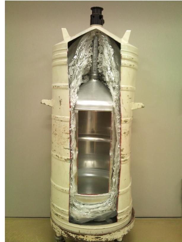
断熱の為に真空層内部に貯層がぶら下がる構造なので
