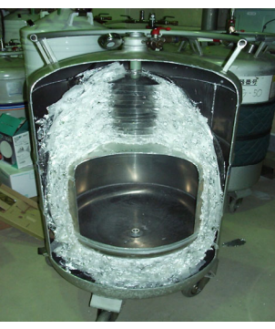
低温容器の断面 (東大物性研低温室 提供)
