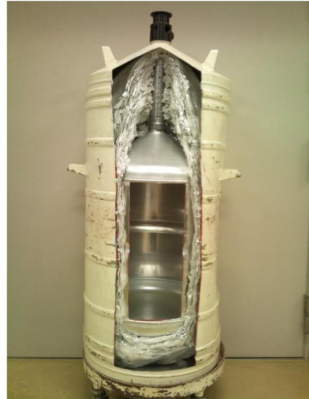
断熱の為に真空層内部に貯槽がぶら下がる構造
