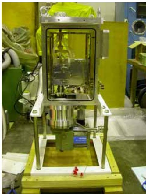
図 14 低雑音増幅器が入れられた冷却デュワー。国立天文台天文機器開発実験センターで組み立てた。
