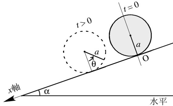
時刻  $t = 0$  での円柱と斜面の接点を原点  $O$  とし、斜面にそって下方に  $x$  軸をとり、円柱の重心の  $x$  座標を  $x_G$ 、円柱の円柱軸まわりの回転角を  $\theta$  (反時計回りを正とし、 $t = 0$  で  $\theta = 0$  とする) とする。また、重力加速度を  $g$  とし、円柱軸まわりの慣性モーメントは  $(1/2)a^2M$  であるとする。
